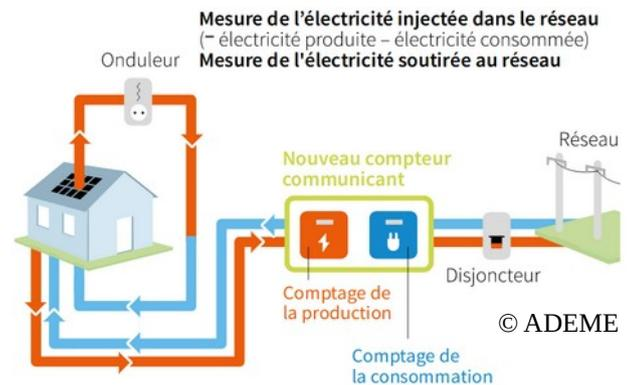
**Installation :** Les panneaux seront idéalement placés sur le toit, pour bénéficier du tarif d'achat, plein sud ( $\pm 25^\circ$ ), inclinés à  $30^\circ$  ( $\pm 20^\circ$ ). Même si ils fonctionnent à une autre orientation / inclinaison, l'éloignement de l'optimum rendra la rentabilisation plus longue. Autre point de vigilance, l'absence d'ombrage proche (cheminée ...) ou éloignée (arbre, immeuble ...). En cas de doute, il est plus prudent de réaliser un relevé de masque solaire.
